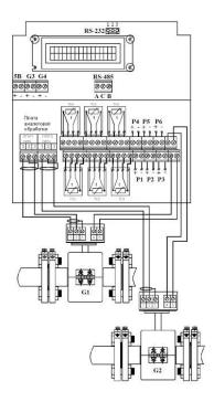
Приведенная ниже схема подключения относится к старой версии теплосчетчика ТЭМ-104. В теплосчетчиках этой модификации для правильной работы температурных датчиков необходимо обязательно закорачивать входы неиспользуемых термосопротивлений.
